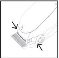
LUBRIQUE REGULARMENTE EL MANGO DE LA CUCHILLA
